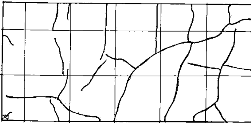
FIGUR 3. Sprickbildning i de första provväggarna.
